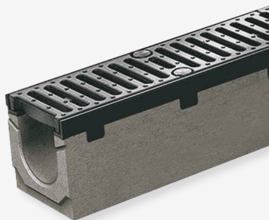
Roostergoot met gietijzeren randbescherming t/m klasse E600. Beschikbaar in breedtes 100,150,200 & 300 mm.
